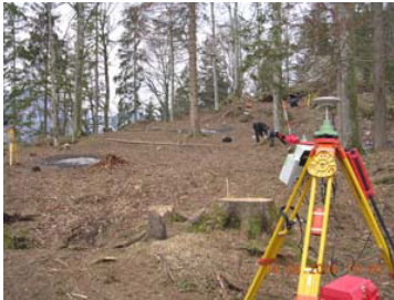
GPS Receiver Leica System 500, aufgebaut im Plateaubereich der Burg.
