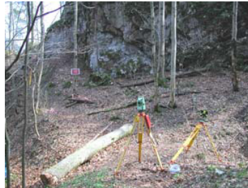
Tachymeter Leica TCR System 700, aufgebaut auf der Nordseite auf dem ehemaligen Zuweg.
